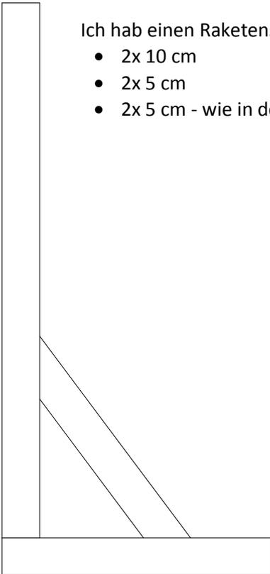
Ich hab einen Raketenstab mit 0,7 cm Kantenlänge in diesen Längen verwendet:
